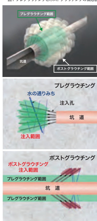
図1 プレグラウチングとポストグラウチングの概念図
