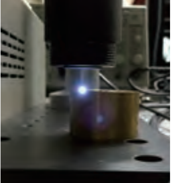
図2 レーザーを用いた炉内 その場分析プローブの開発
